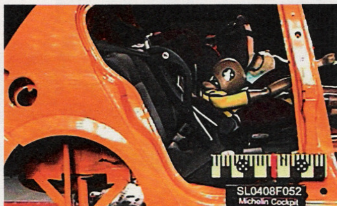
Gefährlich: Weil beim Michelin Cockpit die Gurtführung bricht, taucht das Kind unter dem Beckengurt durch, der sich gefährlich in den Bauch bohrt
