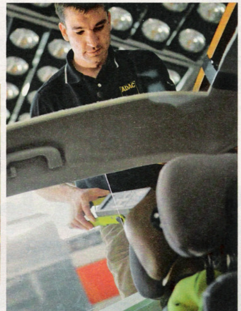
Auf dem Weg zum Unfallort: Nachdem der Kinderdummy mit seinem Sitz korrekt in der Rohkarosserie festgeschnallt wurde, flitzt er im Crashlabor zum Aufschlagpunkt
